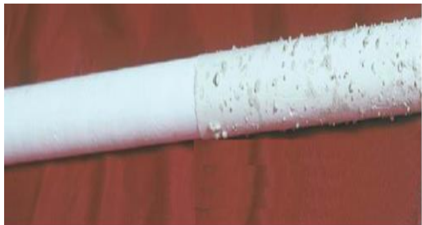
Rodillo con suciedad incrustada
